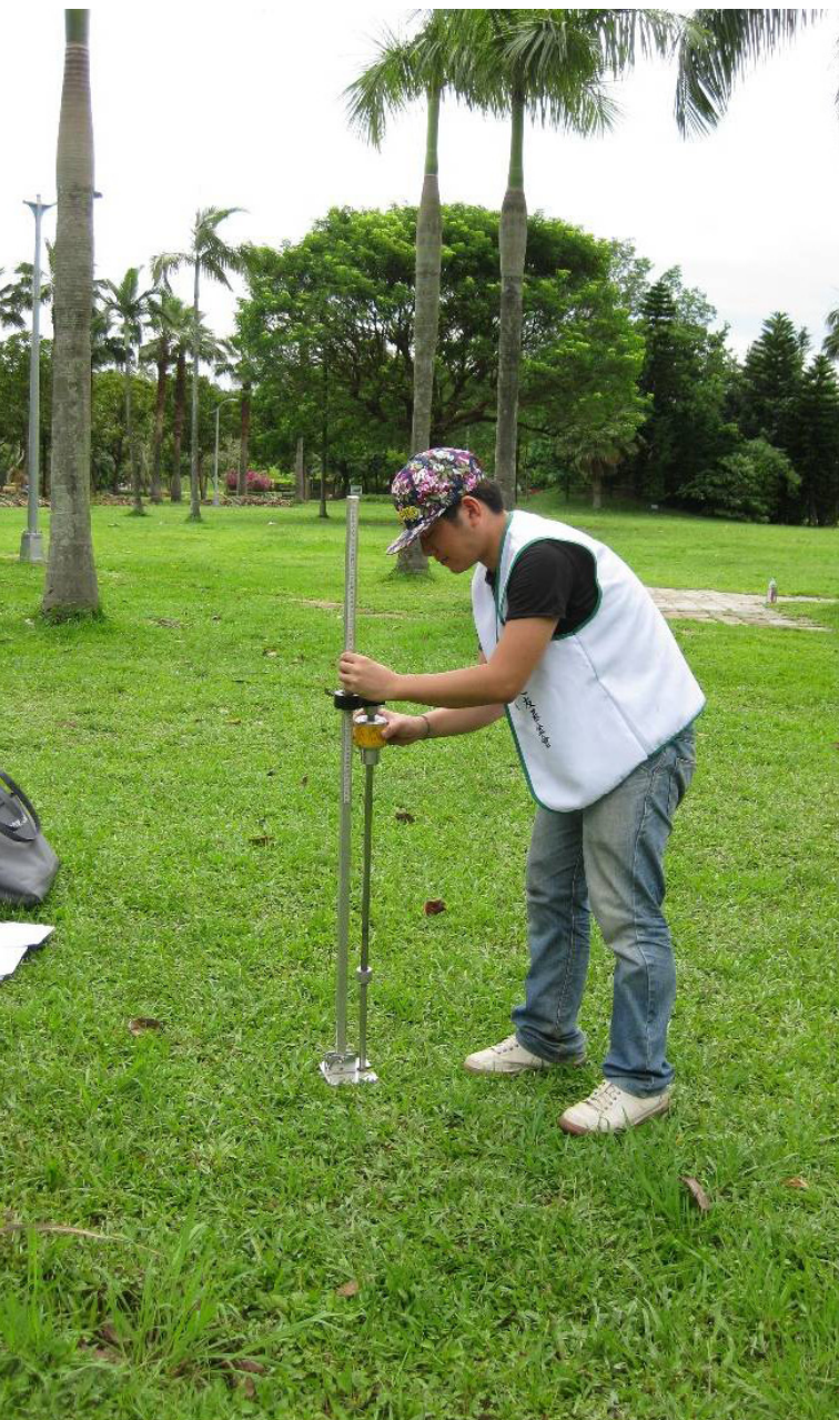
圖 3 長谷川式土壤貫入計的測量 測量從地表面到 60cm 深度的土壤硬度
