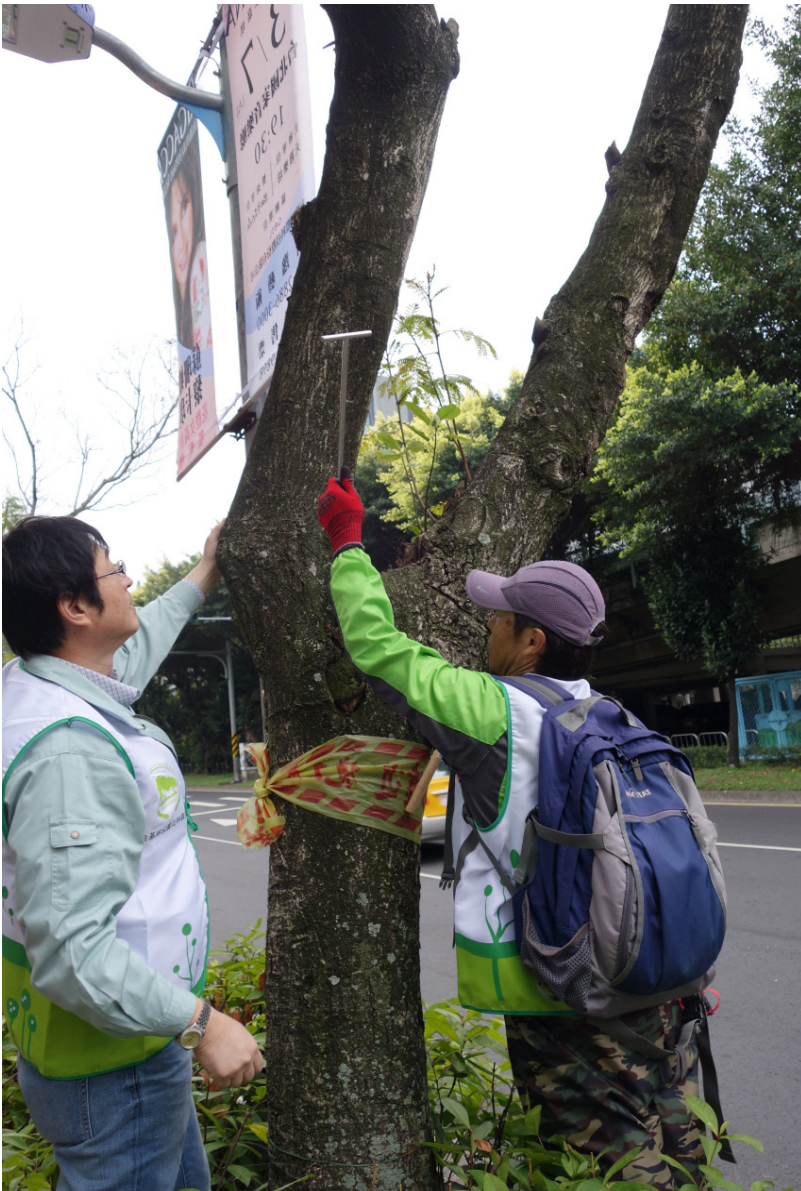
圖 1 貫入抵抗值診斷儀 Resistograph PD600 診斷大安森林公園樹木時所使用的機器。前端細針刺入樹木腐朽處， 依據測試出的抵抗值來判定腐朽程度
