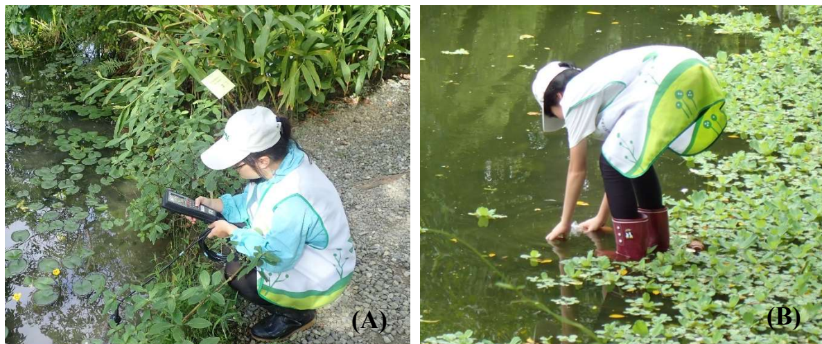
圖 2-5、工作人員現地調查實況。(A) 應用多參數水質儀作現地水質量測； (B) 採集水樣運回實驗室作化學分析。
